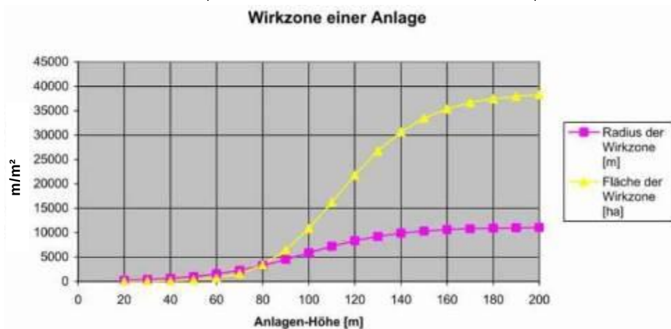
Abbildung 4: Radius und Fläche der Wirkzone einer WEA in Abhängigkeit von der Anlagenhöhe (DNR 2012)
